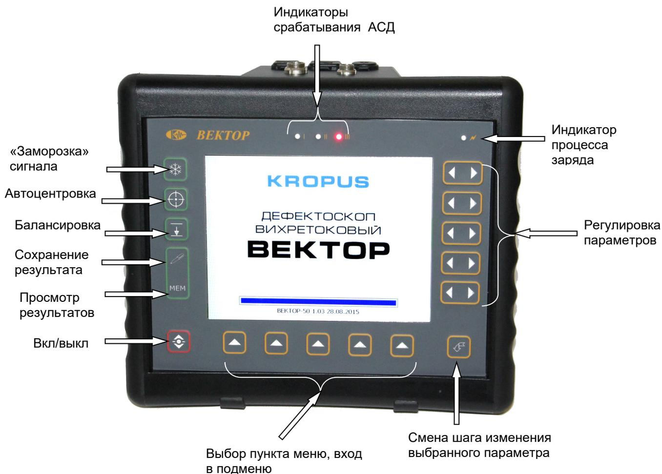
Рис 1-3—Клавиатура дефектоскопа
