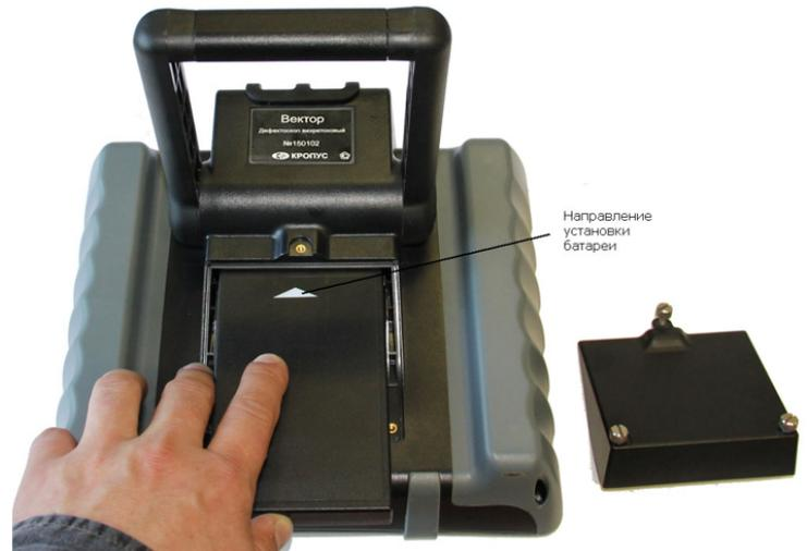
Рис 1-4 Установка нового аккумулятора
