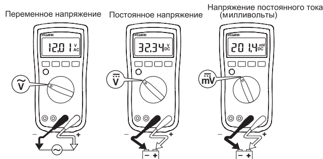
Рисунок 1. Измерение переменного и постоянного напряжения
