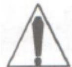
Данный символ, расположенный вблизи другого символа, терминала или работающего устройства, показывает, что оператору следует изучить Инструкцию по Эксплуатации, чтобы избежать травм или повреждения прибора.
