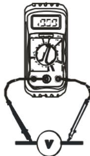
3. Поднесите наконечники испытательных щупов к проверяемой цепи.
