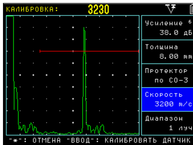
рис.3-13 Калибровка скорости в образце
