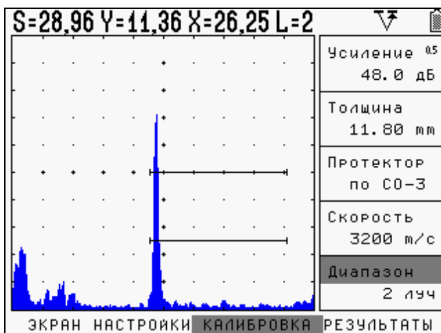
Калибровка для контроля по однократно отраженному лучу
