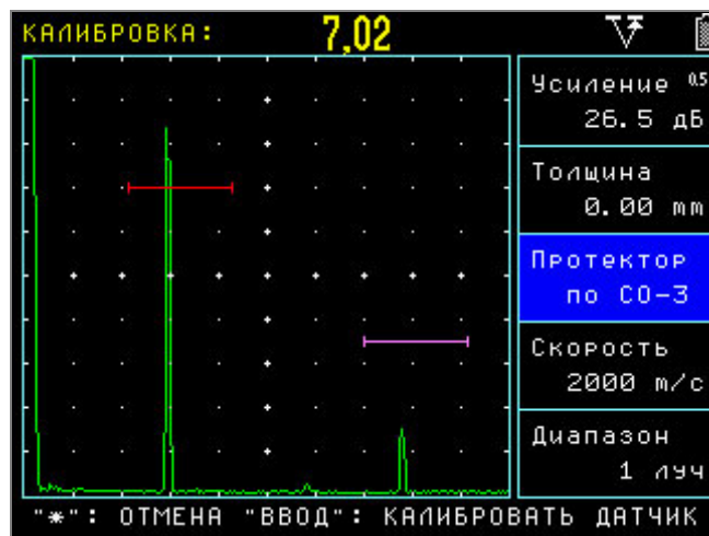
рис.3-8 Калибровка наклонного преобразователя по образцу СО-3
