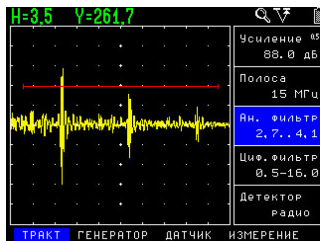
б) Сигналы после включения аналогового фильтра 2,7-4,1 МГц.
