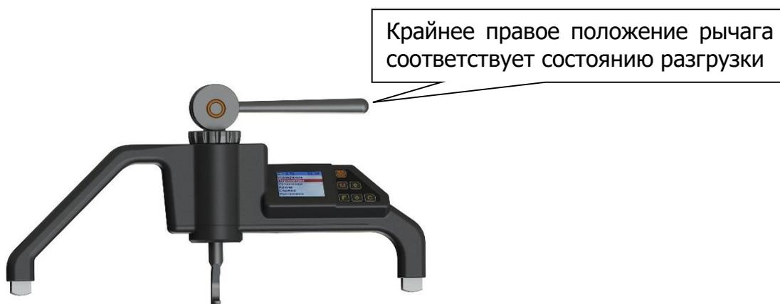
6.1.6 Установить прибор на свободный участок арматурного элемента. В начальном положении между арматурой и крюком будет гарантированный зазор, величина которого будет зависеть от диаметра испытуемой арматуры.
