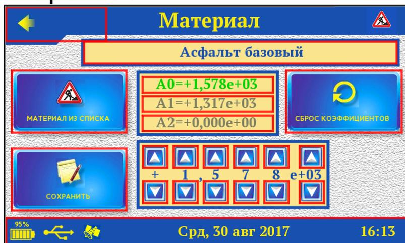
Это подменю позволяет выбрать материал с предустановленными параметрами из списка, изменить название материала, изменить или вернуть (сбросить) к предустановленным коэффициенты характеристики материала. В приборе реализована возможность сохранения характеристик 15-ти различных типов асфальтобетона:
