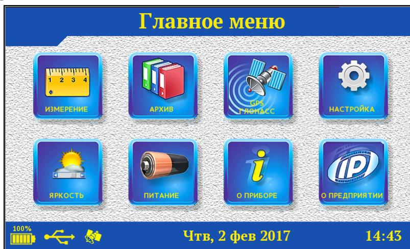
Внизу дисплея расположена статус-строка с символами батареи, питания от внешнего источника или USB-подключения к компьютеру, наличия сигнала со спутников GPS, текущим днем недели, датой и временем.
