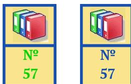
Кнопка запуска измерения содержит номер измерения в архиве. Номер может быть зелёного или синего цвета. Зеленый цвет номера - номер следующего измерения, результата измерения ещё нет в архиве. Синий цвет номера - результат измерения записан в архив.
