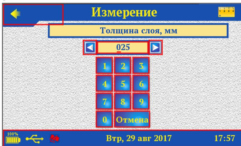
Диапазон установки толщины слоя от 10 до 100 мм (шаг - 1 мм).
