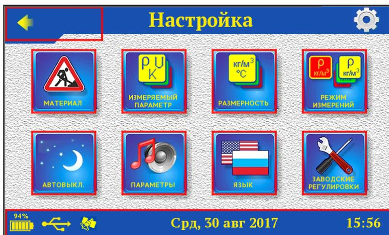
4.4.5.1 Пункт подменю «Материал» меню «Настройка» служит для установки параметров материала, на котором будут производиться измерения.
