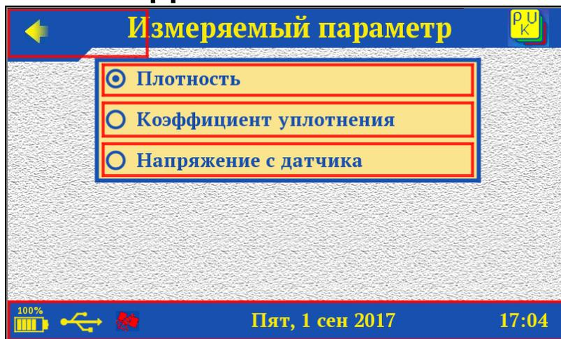
Если выбран измеряемый параметр «**Коэффициент уплотнения**», на дисплее отобразится окно со значением максимальной плотности.
