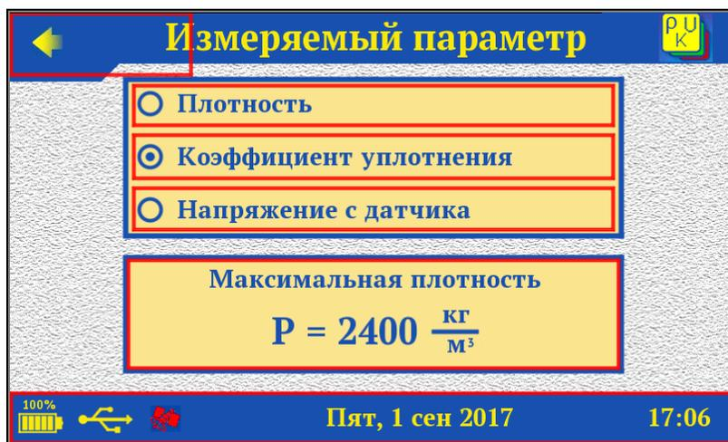
Требуемое значение максимальной плотности (необходимое для определения коэффициента уплотнения) можно установить, коснувшись соответствующего окна. Появится виртуальная цифровая клавиатура для ввода значения.
