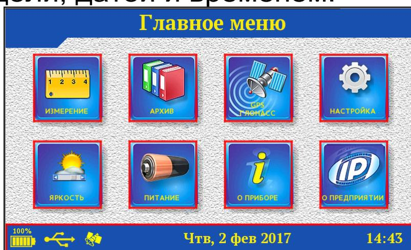
При касании статус-строки, красным контуром выделяются области экрана, касание которых приводит к каким-либо действиям.
