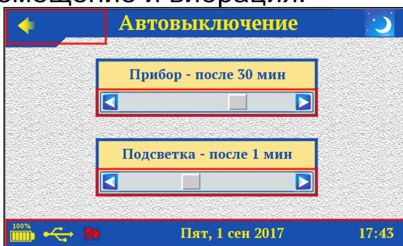
В окне «**Прибор**» касанием одной из кнопок или полосы прокрутки, выберите желаемое значение времени до автоматического выключения прибора при отсутствии действий с ним, либо выберите сообщение «**Не выключать**». Диапазон изменения времени до автовывключения прибора составляет от 2 до 60 минут.
