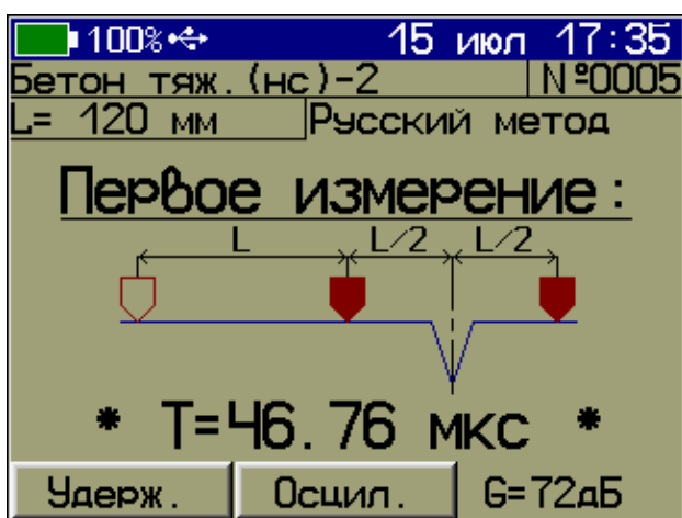
«Русский метод» измерения глубины трещины
