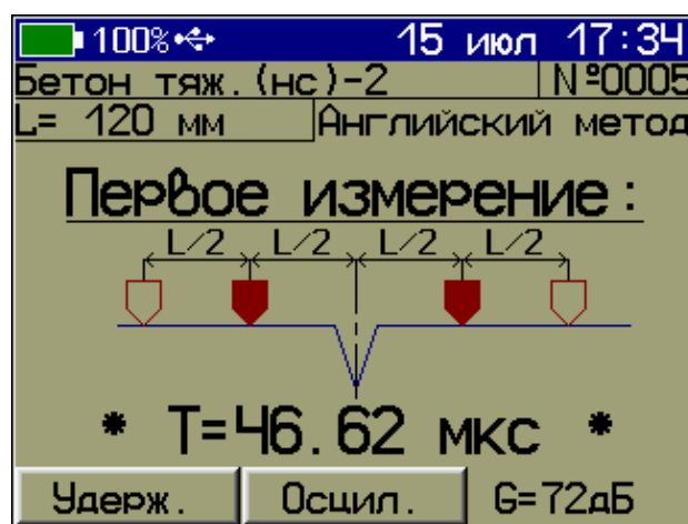
«Английский метод» измерения глубины трещины
