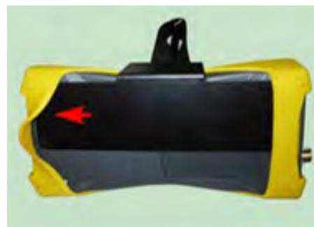
**3.** Ремешок держателя надеть на шею, подключить датчик и наушники. Приемник готов к работе.
