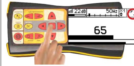
4. Выйти из режима регулировки фильтра нажатием кнопки «частота» **f**. Указатель
