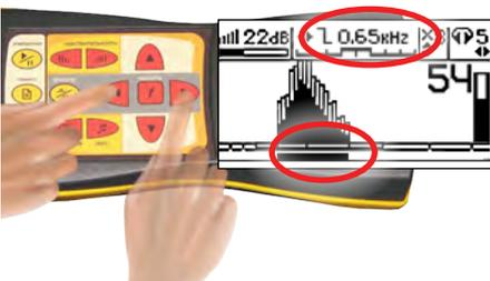
9. Проанализировать качество отфильтрованного сигнала на гистограмме «Спектр» (см. п. 4). Высокая интенсивность черных сегментов (полезный сигнал) при относительно низкой интенсивности светлых сегментов (помехи) и наличии в головных телефонах звука утечки означает правильность настройки фильтра.
