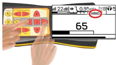
Рекомендуется использовать режим «Утечка» при трассировке трубопровода с использованием ударного механизма и при поиске места дефекта кабеля с применением генератора высоковольтных импульсов для предварительной локализации источника импульсного шума и настройки полосы пропускания частотного фильтра в окне индикации «Спектр».
