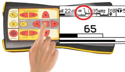
6. С помощью кнопок ◀/▶ понижать верхнюю частоту «среза»  $\downarrow$  0.95kHz до тех пор, пока это не наносит ущерб разборчивости звука в головных телефонах
