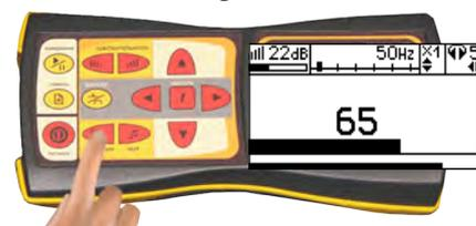
**11. Месту утечки соответствует точка с максимальным уровнем «полезного» сигнала**
