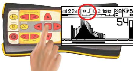
6. С помощью кнопок **◀/▶** повышать нижнюю частоту «среза» **↕ 0.2 1kHz** до тех пор, пока это не наносит ущерб разборчивости звука в головных телефонах.
