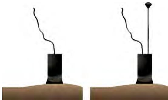
При работе исключите нажим на датчик, т.к. при этом чувствительный элемент может упираться в механический ограничитель вертикального перемещения, что приведет к появлению в головных телефонах посторонних звуков и искажению сигнала.
