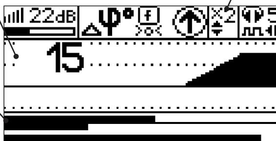
**«Нижняя» шкала** отображает уровень входного сигнала регулируемый кнопками «чувствительность» . Здесь нельзя допускать «зашкаливания»
