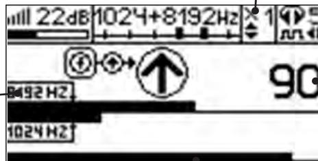
**«Цифра»** отображает суммарный уровень двух частотных составляющих сигнала в условных единицах (0...100)
