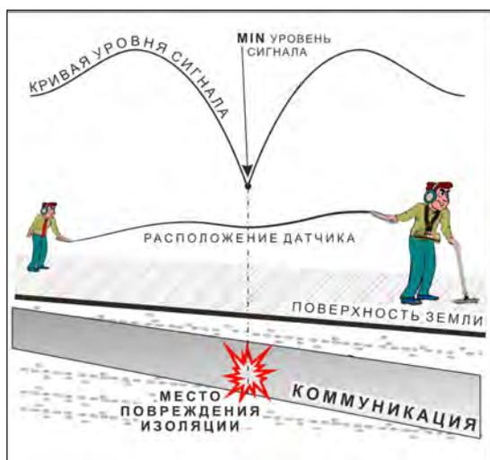
применение датчика-определителя дефектов коммуникации (ДОДК) методом min
