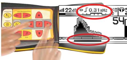
7. Нажать кнопку «частота» **f**. На индикаторе появится символ подавления верхних частот **L**
