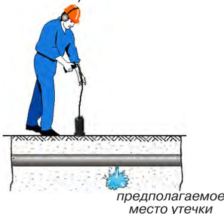
2. Услышав звук, напоминающий звук утечки жидкости, включить полосовой фильтр кнопкой
