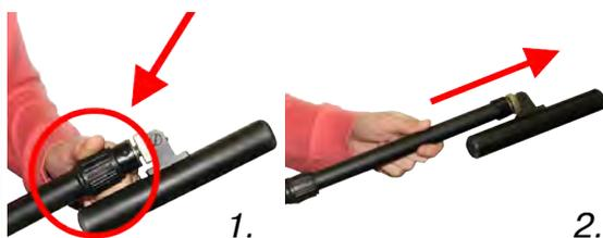
1.2 Ослабить фиксирующую гайку (3) и установить электромагнитную антенну (4) датчика в положение, используемое в трассопоиске. Зафиксировать положение фиксирующей гайкой. Горизонтальное положение – трассопоиск по методу максимума, транспортное положение – трассопоиск по методу минимума
