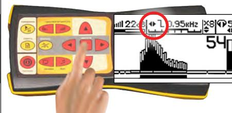
8. С помощью кнопок **◀/▶** понижать верхнюю частоту «среза» **↕ 0.95kHz** до тех пор, пока это не наносит ущерб разборчивости звука в головных телефонах.
