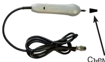
Датчик имеет встроенный предусилитель и два режима работы - режим электромагнитного датчика и режим индикатора переменного электрического поля. Используется для выбора кабеля из пучка, для поиска скрытой проводки и мест обрыва кабеля.
