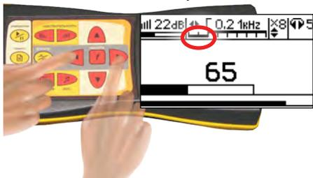
5. Нажать кнопку «частота» f. На индикаторе появится символ подавления верхних частот  $\downarrow$
