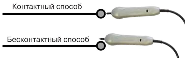
В режиме индикатора электрического поля датчик позволяет проводить отбор «своего» кабеля без создания в коммуникации переменного тока (на рисунке ниже), поиск мест прохождения скрытой проводки и мест обрыва небронированного кабеля при наличии к нему непосредственного доступа.
