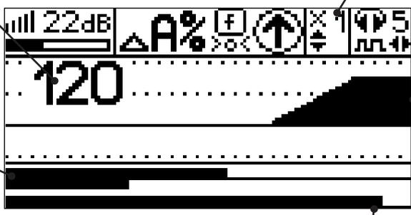
Показания «ΔА%» могут быть отрицательными (график «вниз»), «набегающими» в процессе удаления от генератора. Такие показания рекомендуется периодически «обнулять» (точно над трассой) кнопкой **f** (📶).
