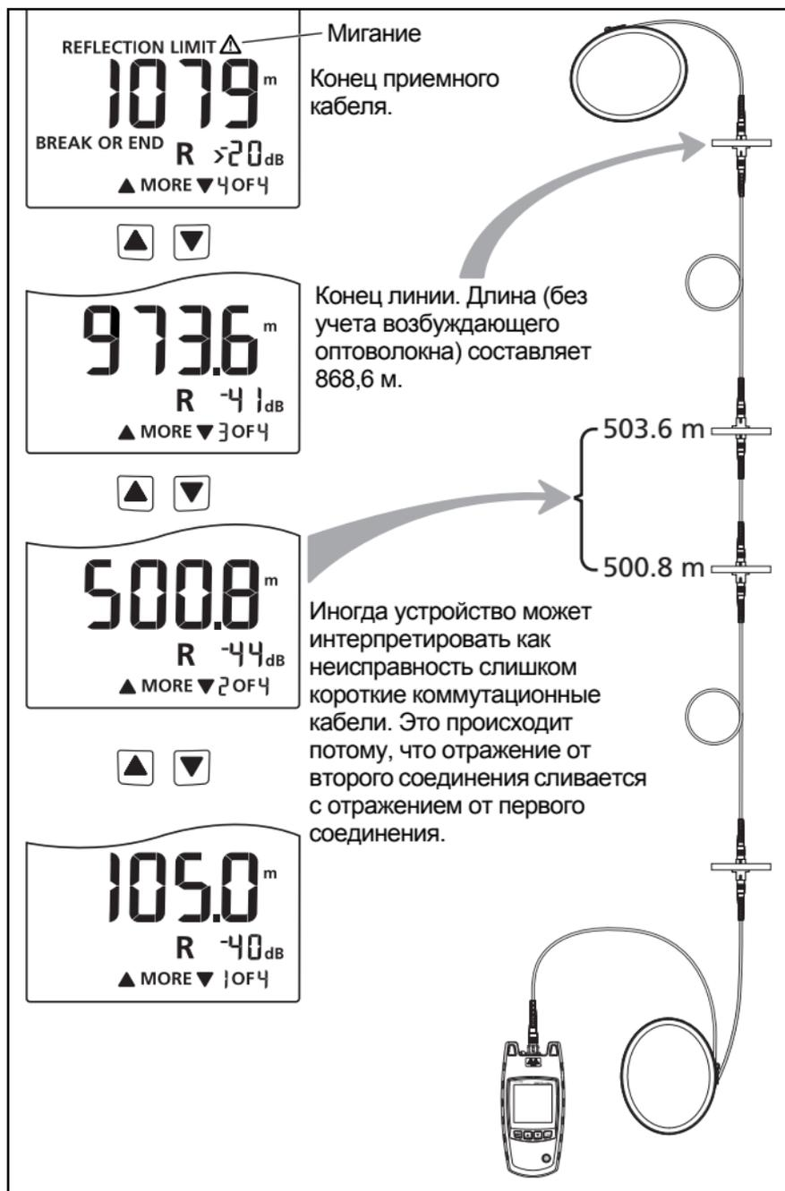
Рисунок 7. Результаты измерений с использованием короткого коммутационного кабеля
